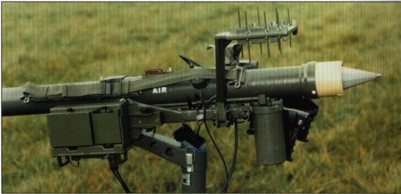
B-68. Interrogator krótkiego zasięgu zamontowany na przenośnej wyrzutni przeciwlotniczych pocisków rakietowych (
