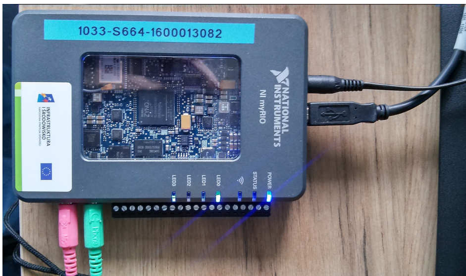
Rysunek 8.2. Zdjęcie laboratoryjnego zestawu uruchomieniowego NI myRIO-1900
