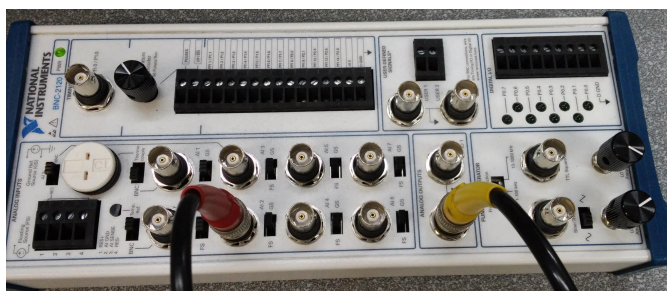
Rysunek 1.4. Typowe podłączenie interfejsu NI przez modul BNC-2120
