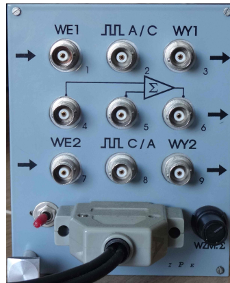
Rysunek 1.1. Panel gniazd BNC dołączonych do karty dźwiękowej
