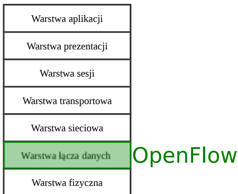
Rysunek 3: OpenFlow w modelu ISO OSI
