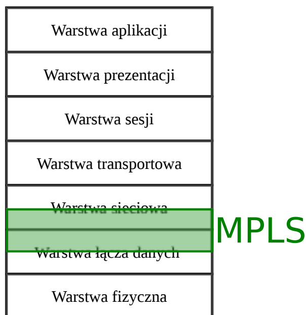
Rysunek 1: MPLS w modelu ISO OSI
