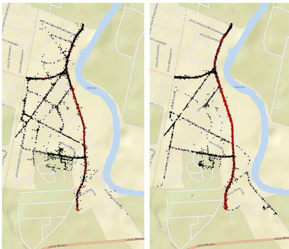
Rys. 5. Ślady GPS pojazdów o prędkości chwilowej poniżej (●) i powyżej (●) 70 km/h: dojeżdżających tranzytowych
