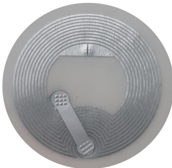
Rysunek 2. Tag NFC NTAG216 o pojemności 924 bajtów (zdjęcie własne).
