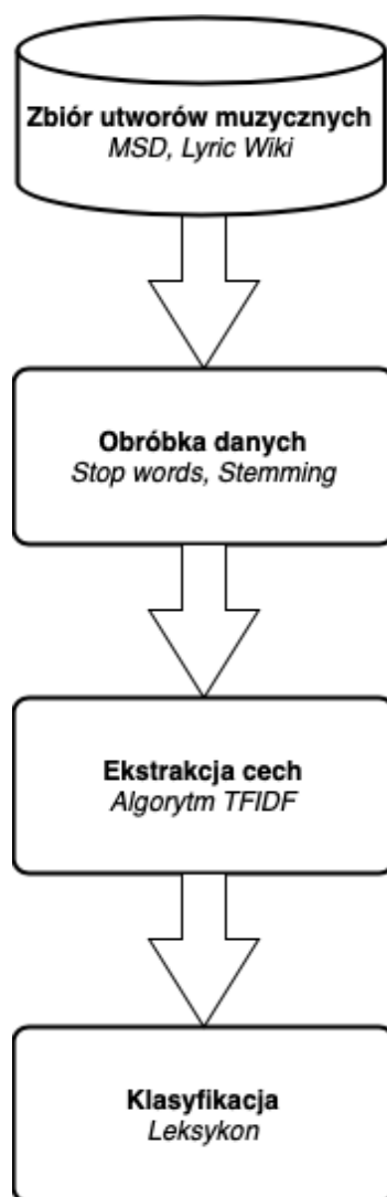
Rysunek 6.6. Proces analizy przy pomocy metody słownikowej wykorzystującej leksykon
